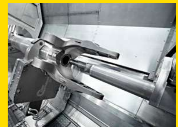
Titan 5553 (Ti5Al5V5Mo3Cr) gilt als Wunschwerkstoff für die Fahrwerksproduktion in der Luftfahrtindustrie. Es zeichnet sich durch verbesserte Festigkeit, Zähigkeit und erhöhte Warmfestigkeit aus. Jedoch zählt „Titan triple-five three“ zu den momentan am schwersten zu bearbeitenden Werkstoffen.
