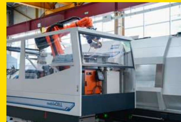
Das FTF (Fahrerloses Transportfahrzeug) holt sich im Lager (Warehouse) die angeforderten Werkzeuge und Werkstücke, fährt dann vor die Maschine, verriegelt sich am Boden und wechselt Teile und/oder Werkzeuge.
