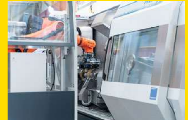
Das FTF (Fahrerloses Transportfahrzeug) holt sich im Lager (Warehouse) die angeforderten Werkzeuge und Werkstücke, fährt dann vor die Maschine, verriegelt sich am Boden und wechselt Teile und/oder Werkzeuge.
