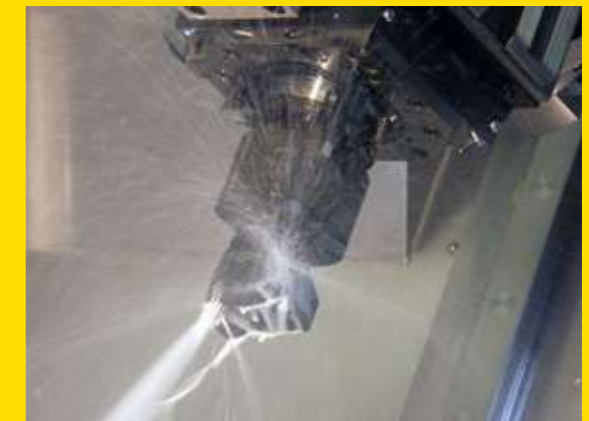
Der Kühlschmierstoff kann dank der eigenen Spindelentwicklung mit einem Druck von bis zu 200 bar durch die Frässpindel direkt an die Schneide zugeführt werden. Dadurch ist ein schneller und kontinuierlicher Spanabtransport gewährleistet.
