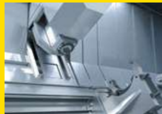
Einzelwerkzeugträger mit B-Achse in Drehausführung
