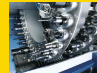
max. Tool length M30/M30-G: 450mm; M35/M35-G: 450/600mm
