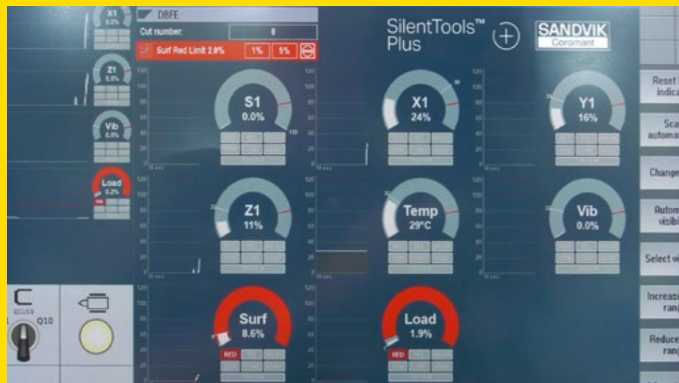
ANZEIGE Auf der Bildschirmanzeige werden präzise Daten für Belastung, Oberfläche, Vibrationen und Temperatur im Dämpfungssystem sowie die Schnittzeit angeführt.
