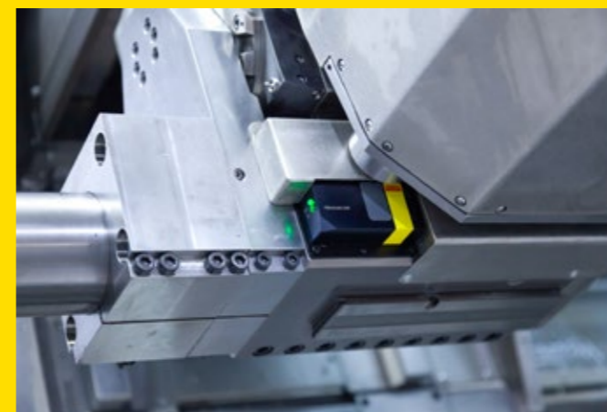
NEU Die Energieversorgung der Sensoren erfolgt mittels Induktivkopplung.
