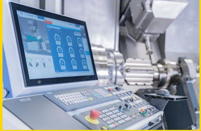
Höhenverstellbares und schwenkbares Bedienpult mit neigungs-verstellbarem 24-Zoll Bildschirm
