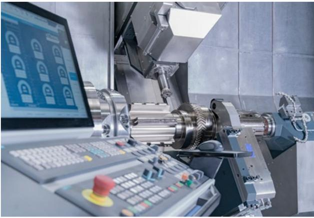
Die M70 MILLTURN überzeugt mit einem durchdachten Arbeitsraumkonzept für Bearbeitungslängen bis zu 8000 mm und einem Umlaufdurchmesser von bis zu 850 mm.
