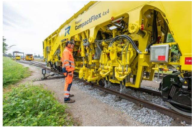
Vielseitige Lösungen für weltweite Gleisstandhaltung: Mit der Compact-Serie von Plasser & Theurer wird das gesamte Spektrum von Stopfung über Stabilisierung bis Profilierung abgebildet.
