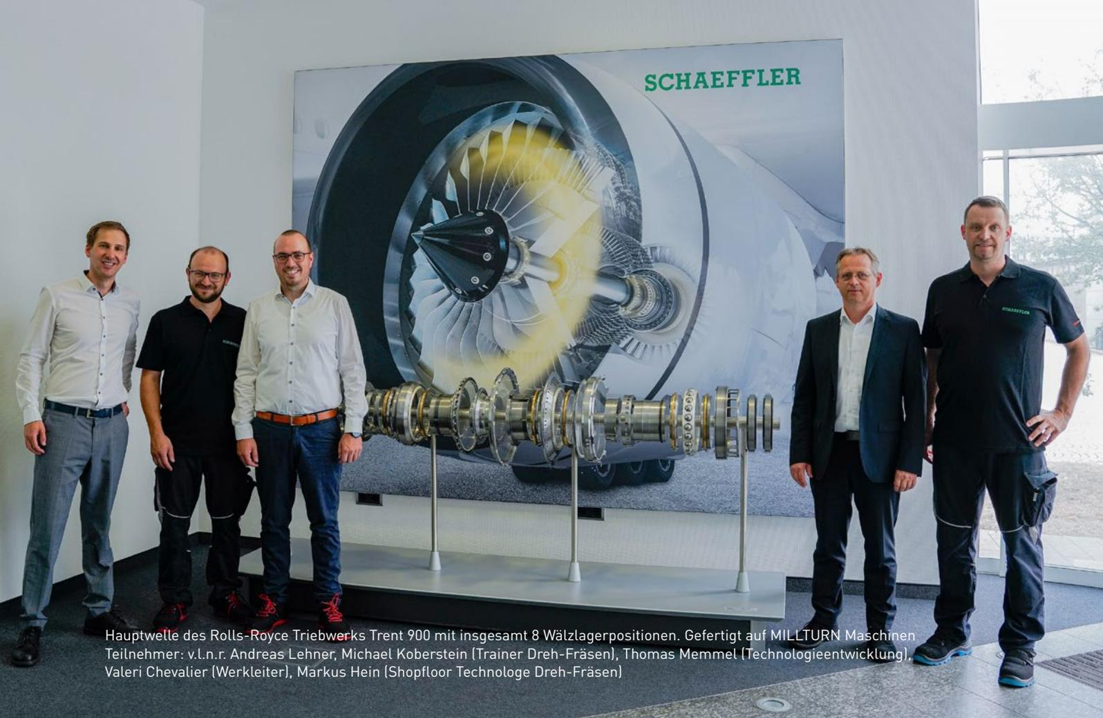
Hauptwelle des Rolls-Royce Triebwerks Trent 900 mit insgesamt 8 Wälzlagerpositionen. Gefertigt auf MILLTURN Maschinen
