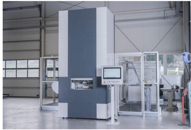
Der Speicherturm hat eine maximal Höhe von 5,9 Metern.
