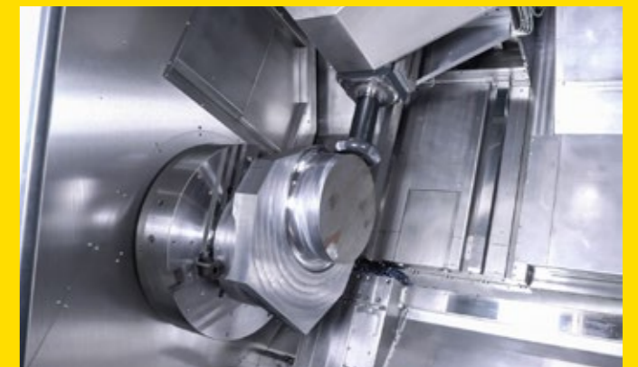
Vibrationsfreies Bearbeiten dank der Schwingungsdämpfer nahe der Werkzeugschneide.
