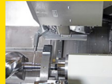
Werkstückvermessung mit Messtaster an der DBF-Einheit.
