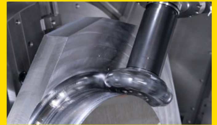
Fertigung von Undercuts in höchster Präzision.
