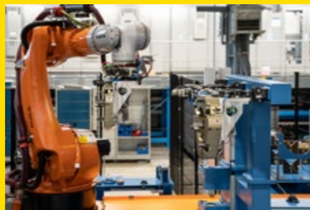
Greiferwechsel im Greifer-Bahnhof
