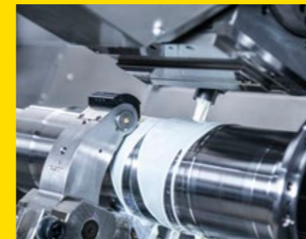
Bei der Ultraschall Wanddickenmessung wird das Signal über das Kühlmittel übertragen.
