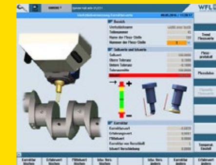
Anzeige der Messung (Istwert, Sollwert, Toleranzen, ...) am Steuerungsbildschirm.
