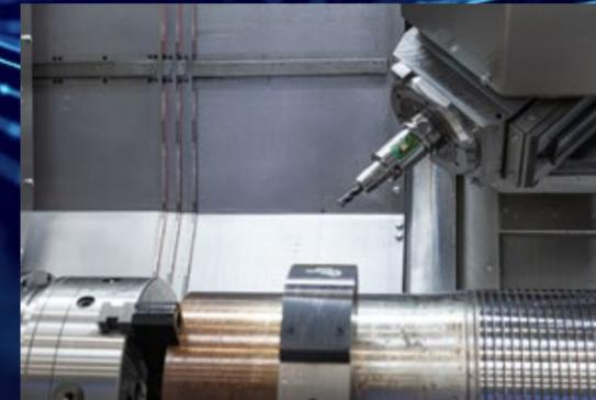
Das ICOTronic Tool im Einsatz. An der Maschine erfolgen aktuell Tests mit einem „sensored tool“, welches in der Werkzeugaufnahme Sensoren zur Kommunikation mit der Maschine verbaut hat. Die Sensorik erleichtert den Workflow erheblich und optimiert nicht nur den Fräsprozess, sondern steigert auch die Produktivität der Maschine.
