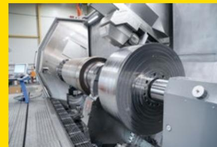
WFL realisiert bis zu 60 Tonnen Werkstückgewicht.
