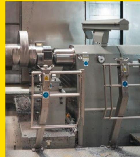
Zur Erfassung der Werkstücktemperatur wird ein Handmessgerät mitgeliefert. Über ein NC-Unterprogramm kann z. B. unmittelbar vor der finalen Bearbeitung einer engen Passung automatisch ein Menübild eingeblendet werden, welches den Bediener auffordert, die aktuelle Werkstücktemperatur zu messen und ins Menübild einzugeben.
