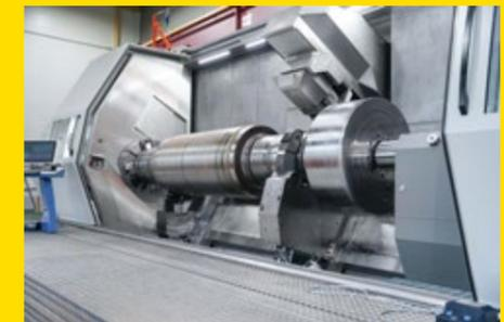
Geschlossener Arbeitsraum für Bearbeitung mit hohen Kühlmitteldrücken und -fördermengen sowie Späneableitung für automatische Austragung.
