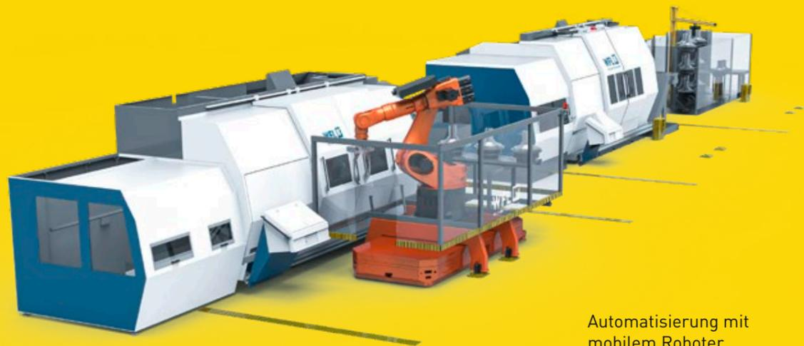
Automatisierung mit mobilem Roboter
