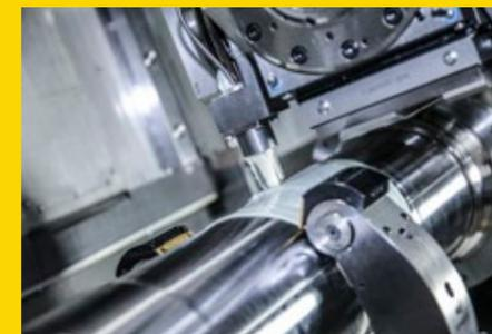
Automatisches Ultraschallmessen (In-Process)
