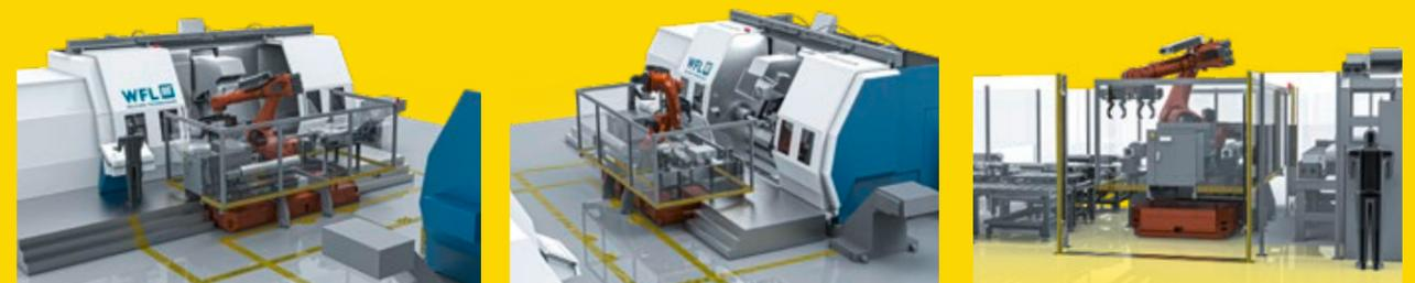
Automatisierung mit mobilem Roboter ummantelt mit einem Schutzzaun zur Sicherheit der Mitarbeiter.
