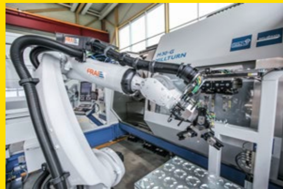
Eine der flexibelsten Varianten der Automatisierung von Produktionsmaschinen ist der Knickarmroboter in einer Roboterzelle.
