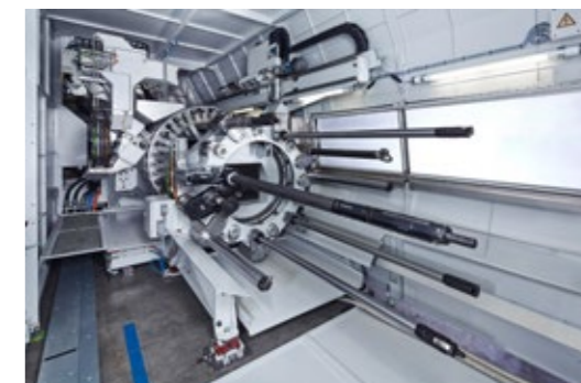
Mittels Pick-Up Magazin und Prismenwerkzeugwechsler erfolgt ein automatischer Werkzeugwechsel mit langen Werkzeugen.
