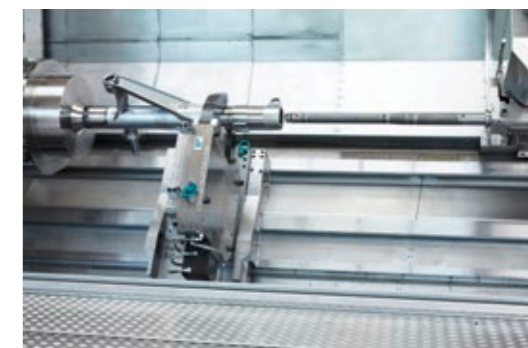
Bei Materialien wie Inconel oder Titan ist das Tieflochbohren besonders schwierig, weil die Wendepplatten stark verschleifen. Als Maschinenhersteller benötigt man dabei ein umfassendes Know-how.
