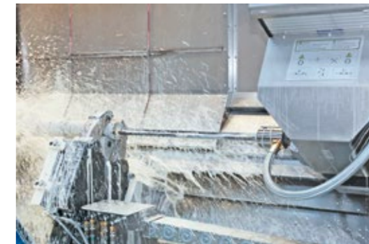
Für kleine Bohrdurchmesser wird das Kühlmittel direkt durch die Frässpindel mit einem Kühlmitteldruck von max. 200 bar zugeführt. Bei größeren Bohrdurchmessern ist das Kühlmittelvolumen entscheidend.
