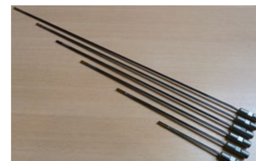
Der Einsatz abgestufter Bohrwerkzeuge für extrem tiefe Bohrlöcher ist über das Werkzeugmagazin im Bearbeitungszentrum ohne großen Aufwand möglich.
