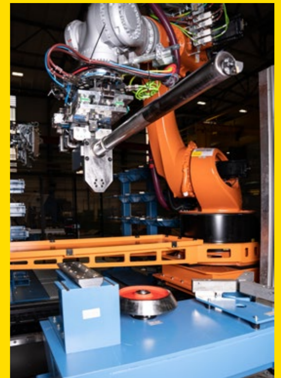
Mit dem Rüstplatz können Werkzeuge hauptzeitparallel gerüstet und neue Werkstücke eingeschleust werden, ohne dabei die Automation einzuschränken.
