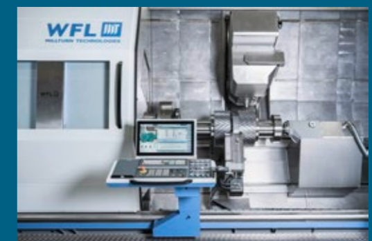
M80X MILLTURN mit 4500mm Spitzenweite – Bearbeitung einer Getriebewelle. Erleben Sie die Live-Zerspanung einer Getriebewelle mit Ø 800mm, einer Länge von 1824mm und einem Gewicht von 2280kg.
