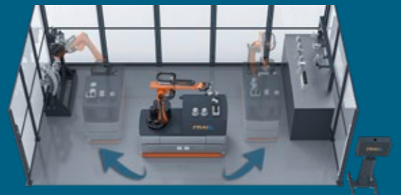
Mobile Robot Automation: Live demonstriert wird das Ein- und Auswechseln von Werkzeugen und Werkstücken mit einem mobilen Roboter.
