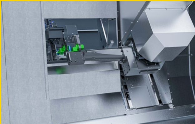
Werkzeugwechsel aus dem Werkzeugmagazin erfolgt über die Werkzeugwechsel-Klappe direkt auf den Winkelkopf.
