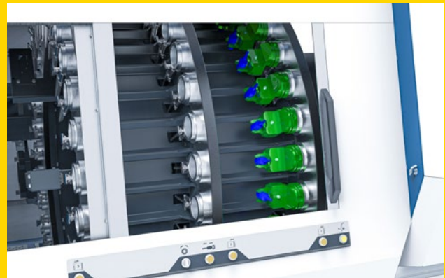
Im Standardwerkzeugmagazin werden die verschiedenen Werkzeuge im Adapter abgelegt und es kann automatisch darauf zugegriffen werden.
