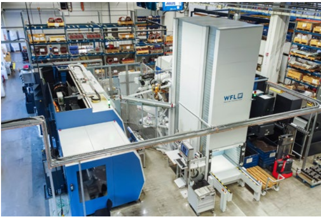
Die beiden M65 MILLTURNS mit Automatisierung und Speicherturm sind die neuesten Anschaffungen der Firma Aerzen.
