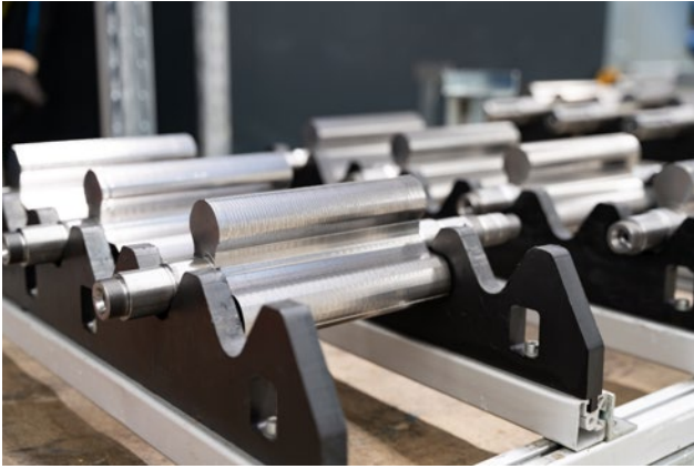
Das Rohteil hat drei Flügel. Die Ausrichtung muss daher exakt stimmen, damit der Roboter mit dem Jochgreifer arbeiten kann.
