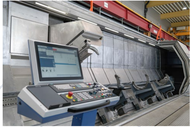
Diese 12 Meter lange M100 MILLTURN verfügt über eine spezielle Konfiguration, die für die Bearbeitung von langer rohrförmiger Teile ausgelegt ist.
