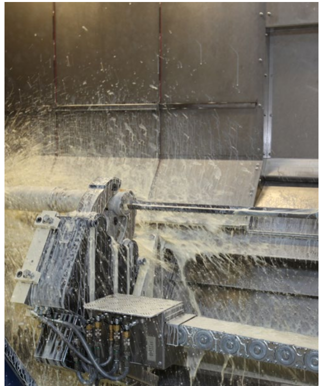
Das gesamte Spektrum der WFL-Kompetenz im Bereich der Innenbearbeitung. Integriertes Tiefbohren auf einem Millturn-Komplettbearbeitungszentrum. In diesem Fall mit einem Einlippenbohrer.
