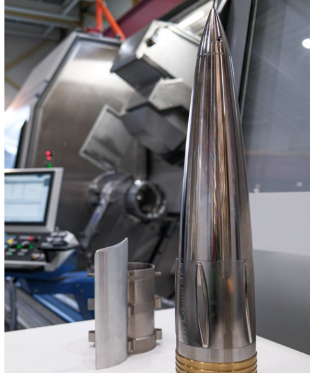
Eine der Stärken von WFL ist die Fähigkeit, sowohl die Außen- als auch die Innenbearbeitung von Hülsen anzubieten.
