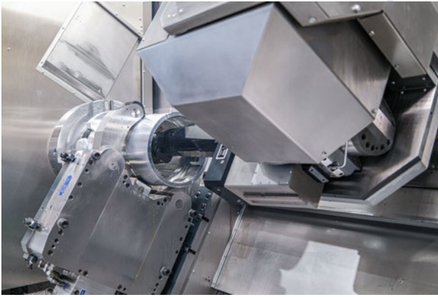
Innenbearbeitung mit dem Hochleistungskopf von WFL mit automatischem Werkzeugwechsel.
