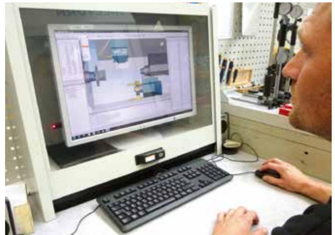
**6** Software für kurze Rüstzeiten: In der Programmierabteilung sowie direkt an der Maschine stehen die Simulations- und Optimierungstools von WFL wie Crash Guard Studio und Millturn Pro zur Verfügung (© Audi)
