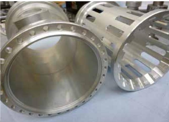
**4** Zwei weitere Bauteile, die wie gemacht sind für die Komplettbearbeitung in einer Aufsinnung auf der M35-G Millturn, die dafür reichhaltig inklusive eines Revolvers und Gegenspindel ausgestattet wurde (© Audi)
